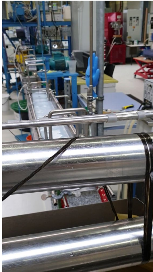
Apparatur zur Strangpräparation für die Gewinnung von Flockfasern aus Basalt
