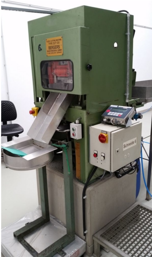
Schneidapparatur zur Herstellung von Flockfasern aus Basalt.
